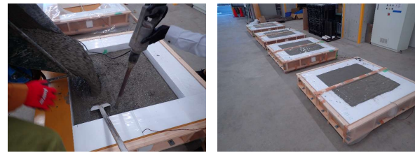
写真-1 打込み状況 写真-2 養生状況
