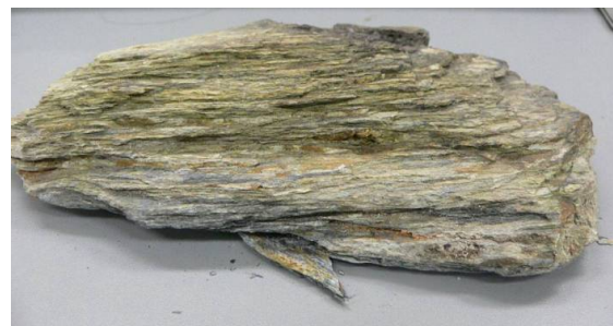
写真-2 スレート劈開の発達した黒色片岩
