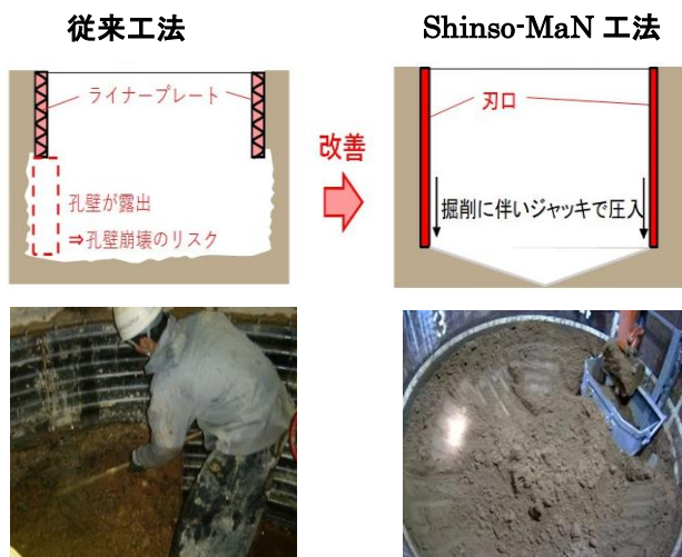
図－2 孔壁の露出状況
