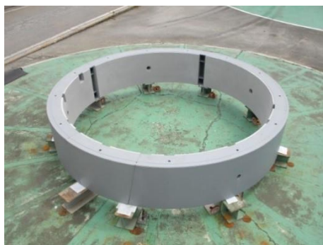
写真2 水平仮組状況
