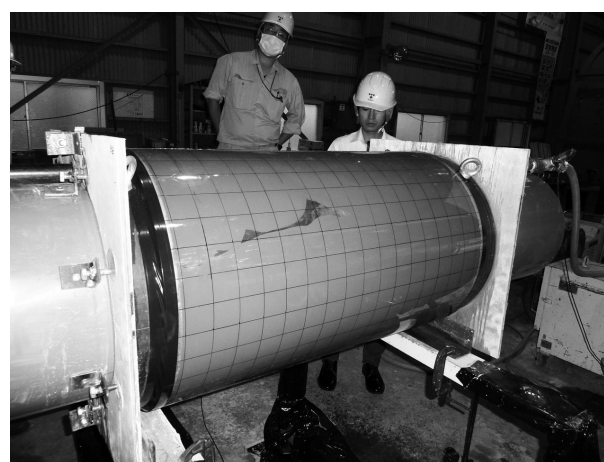
写真-3 注入完了(8 孔/m タイプ)
