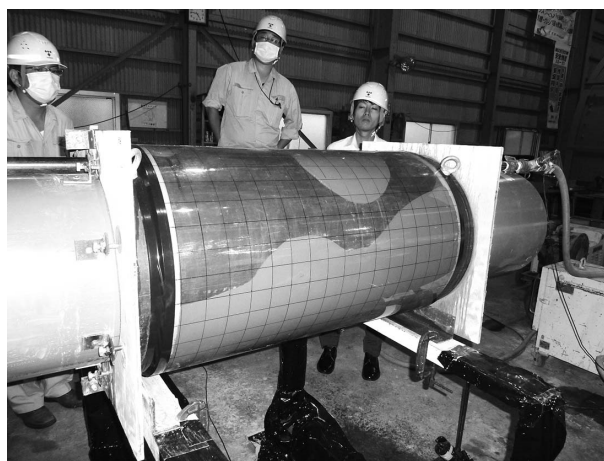
写真-2 注入状況(8 孔/m タイプ)
