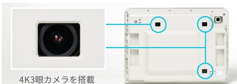
写真2 AIカメラ（配筋検査専用デバイス）
