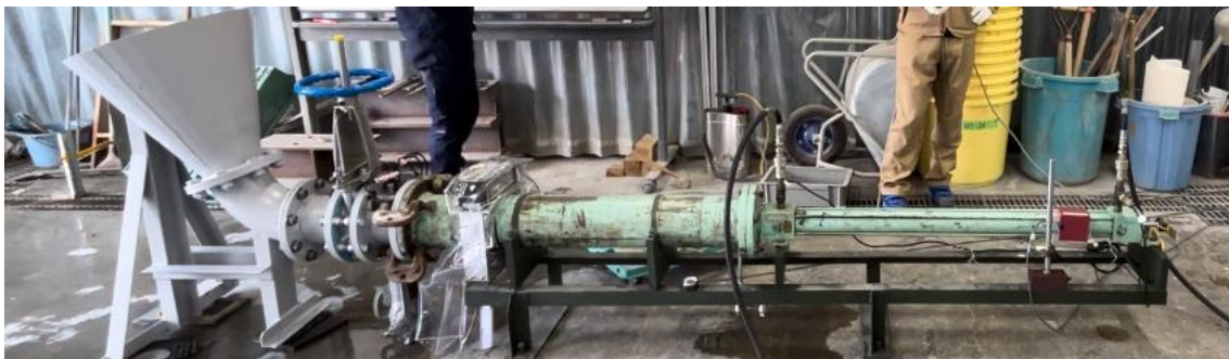
写真-1 コンクリートポンプのピストン部を模擬した試験装置
