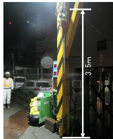
図-13 虚像発生リスクが低い 3D センサ高さ
