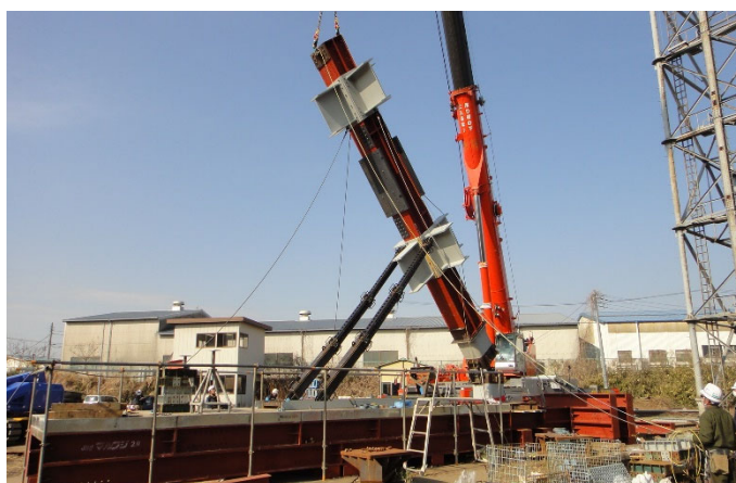
写真1 伸縮式転倒防止治具の性能試験状況
