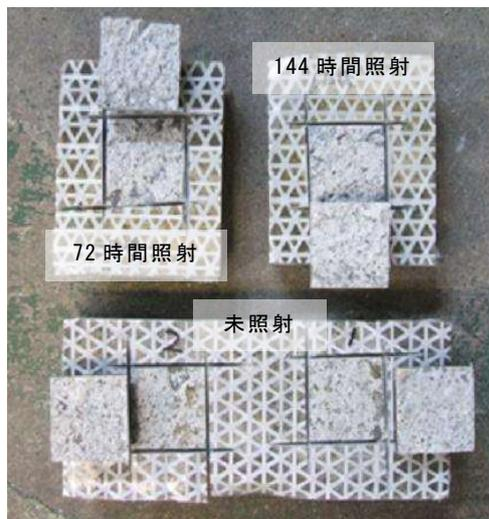
写真－5 促進耐候性試験後の付着状況
