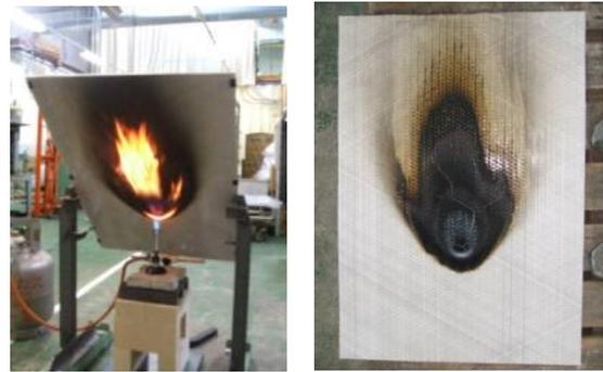
写真－6 延焼性試験状況
