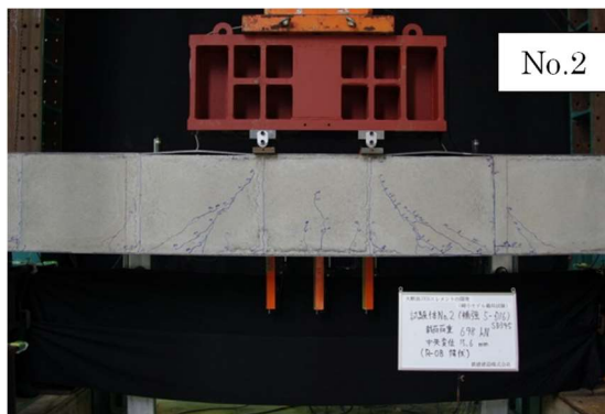
写真-2 補強鋼材降伏時の損傷状況 (変形角 1/101)
