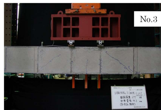
写真-3 補強鋼材降伏時の損傷状況 (変形角 1/91)
