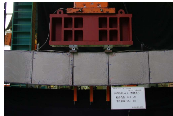
写真-4 変形角 1/50 時点の損傷状況 (No. 1)
