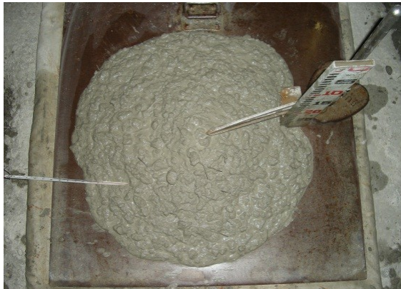
写真-3 試験施工時のスランプ試験状況の一例
