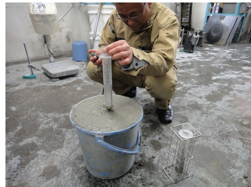
写真-1 円筒貫入試験状況
