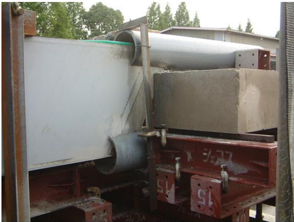
写真-4 塩ビ管切削試験状況
