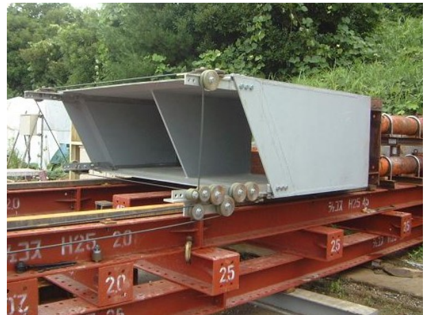
写真-1 気中ワイヤー回転試験状況
