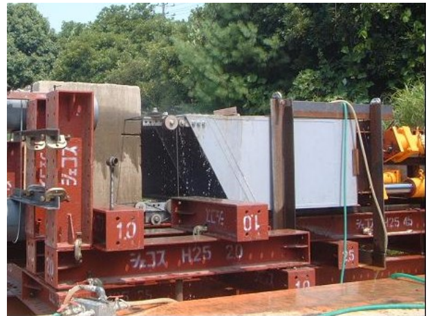
写真－3 抵抗力切削試験状況
