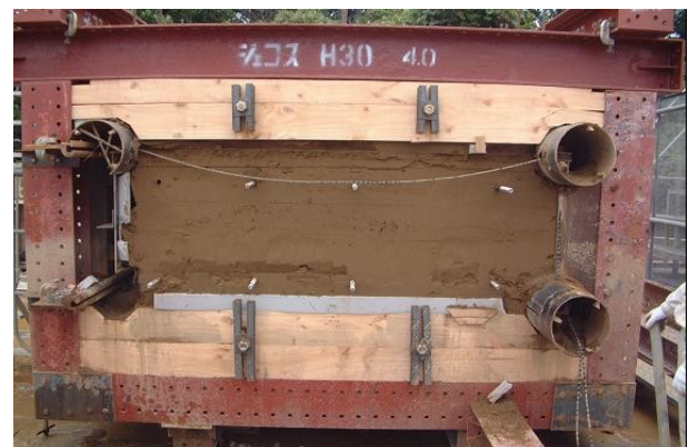
写真-6 土槽切削試験状況（到達側）
