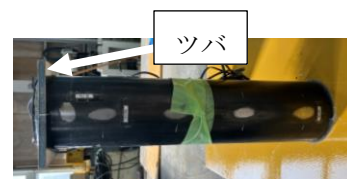
写真-1 モルタル充填鋼管
