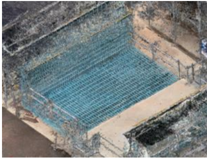
写真－５ SfM 処理による点群データ
