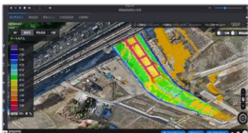
ICT土工による土量の自動管理
