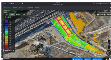
ICT土工による土量の自動管理
